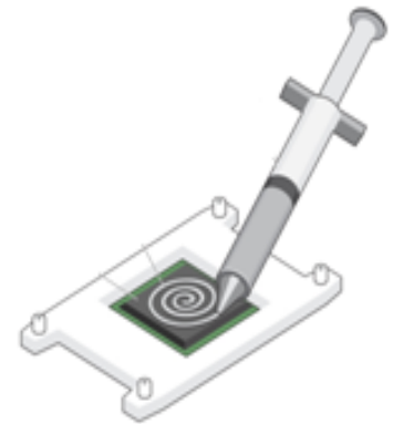
Εικόνα 3Α.7 Τοποθέτηση θερμοαγώγιμης πάστας.
