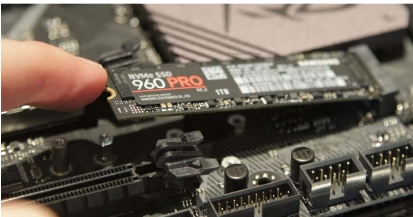
Εικόνα 5.10 Οριζόντια τοποθέτηση M.2
