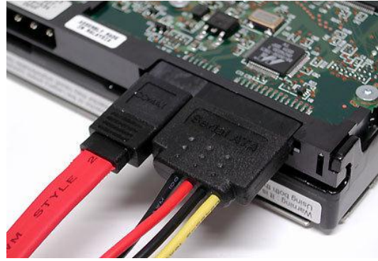
Εικόνα 5.9 Συνδέσεις σκληρού δίσκου SATA
